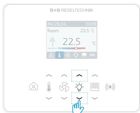
Abb. 040 Lichtverstellung über Pfeiltasten
