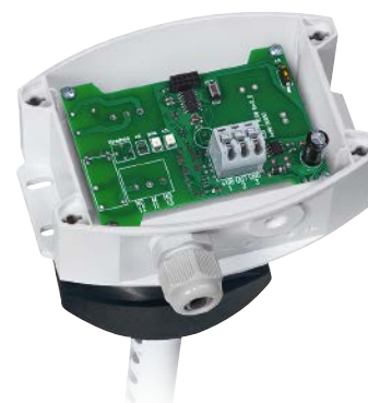
KLGF-U con uscita 0-10V, UB = 24 V
