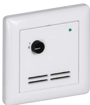
FSTFxxLD2 Versione con sonda, diodo luminoso (verde) e interruttore rotativo (a 2 stadi) (max. 24 V AC / DC, max. 130 mA)
