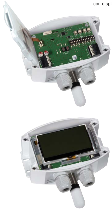
AFTM - LQ - CO2 - Modbus con display
