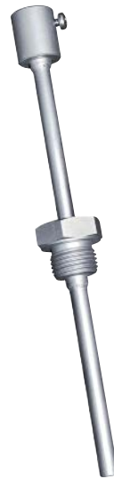
TH08-VA/xx/90 Pozzetto a immersione con collo di estensione in acciaio inox V4A, a tenuta piana, cilindrica, secondo DIN 228
