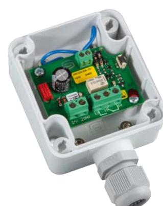
**FONCTIONNEMENT** Le capteur de fuite peut être réglé via l'interrupteur DIP de manière à ce que le relais soit enclenché en régime normal. Cela signifie que, en cas de défaut (dégâts des eaux, câble brisé, panne de courant) le relais est mis au repos. Une rupture de câble vers le capteur peut ainsi être détectée.
