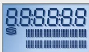
L'écran LCD peut être programmé via l'interface EtherCAT. Si seule une grandeur de sortie est sélectionnée, l'affichage est statique. Il est cyclique si plusieurs grandeurs sont sélectionnées.
