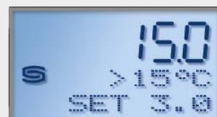
**Dépassement du seuil supérieur de la plage de mesure** - Température réelle augmente au-dessus de +15 °C
