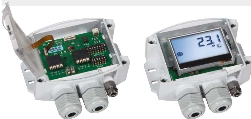
**THERMASGARD® ALTM 2 - Modbus - T3** Sonde de température d'applique pour conduites avec convertisseur
