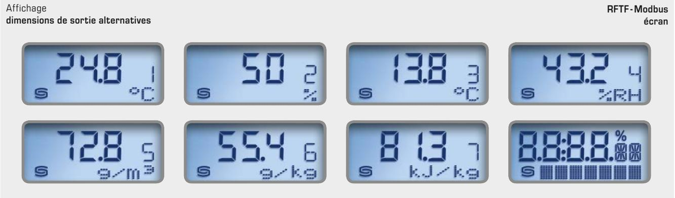
La **température réelle** et l'**humidité réelle** (humidité relative) s'affichent en alternance par défaut. Un écran rétro-éclairé est disponible pour une meilleure lisibilité. Via l'interface Modbus, il est possible de saisir **librement** du texte sur l'écran avec affichage 7 segments ou aussi l'affichage avec matrice de points.
