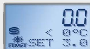
**Dépassement du seuil inférieur de la plage de mesure** - Température réelle descend en-dessous de 0 °C
