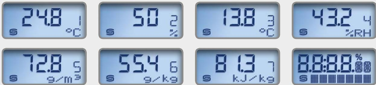
La **température réelle** et l'**humidité réelle** (humidité relative) s'affichent en alternance par défaut. Un écran rétro-éclairé est disponible pour une meilleure lisibilité.
