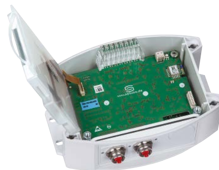
MWTM-EtherCAT P con display y gráfico de barras
