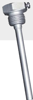
THR -ms-08 /xx Manguito de inmersión de latón niquelado sellado en rosca, cónico, según DIN 10226
