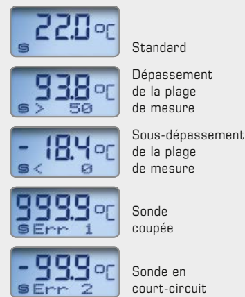
Affichage et propre diagnostic THERMASGARD® Convertisseur de mesure avec écran
